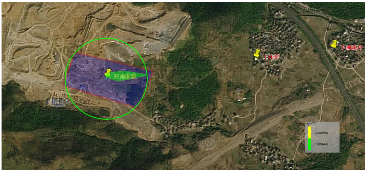
图 6.3.5-12 吡啶桶装料泄漏影响预测图
