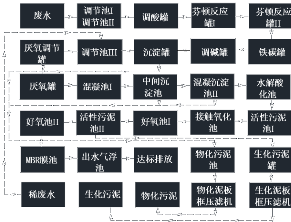
图 3.5.1-1 废水处理工艺流程图
