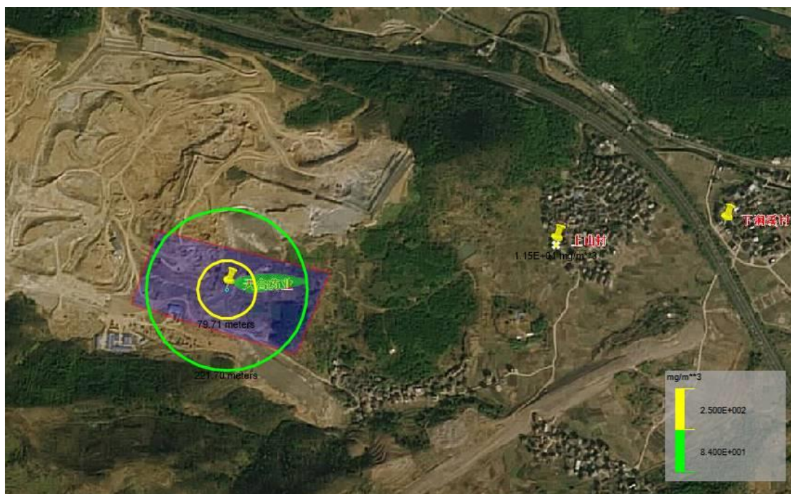
图 6.3.5-6 乙腈储罐泄漏影响预测图
