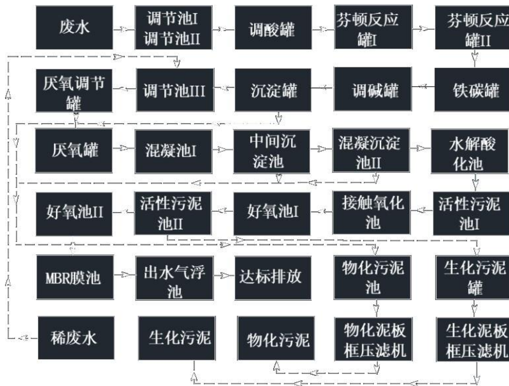
图3.2.4.1-1 废水处理工艺流程图
